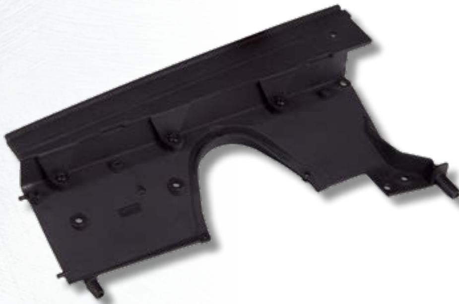
← На изображении представлены две скрепленные детали, образующие левый брызговик моторного отсека.
